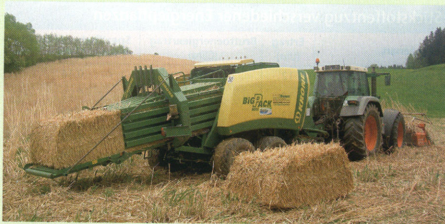
Vorne mäht der Schlepper, über einen Kratzboden fördert er das Erntegut zur Presse.
