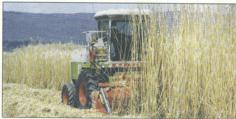
Die Ernte von Miscanthus soll künftig mit einem reihenunabhängigen Selbstfahrhäcksler stattfinden.
